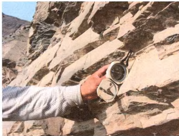
Figura.3.3. Medición de buzamiento del macizo rocoso Fuente. Sociedad Nacional de Minería, Petróleo y Energía 2004.
